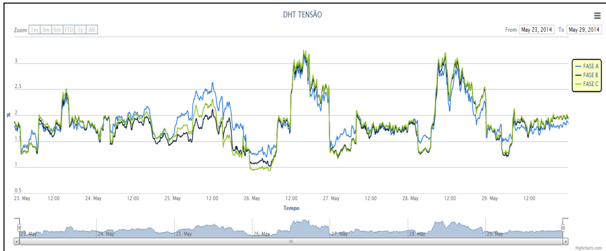
Figura 64. Taxa de distorção harmônica total de tensão medida do transformador DITF4-04 da SE DI.
